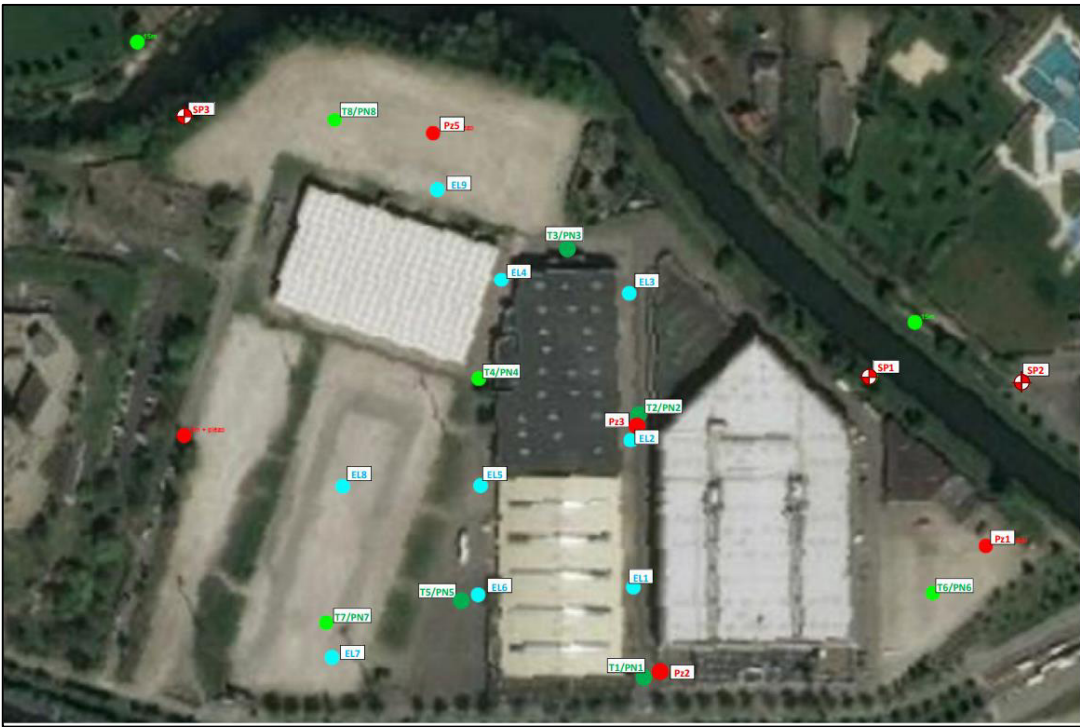
Figure 11 – Implantation des sondages géotechniques sur le périmètre Archipel 2 (Source : Étude géotechnique de conception (G2), avril 2019, Ginger Burgeap)
